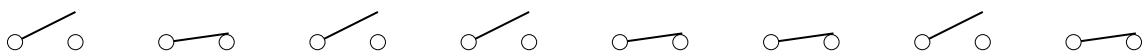
Illustration 1.4: Gruppe von acht Schaltern. Für das hier dargestellte Beispiel schreibt man hierfür auch 0100 1101 (0: offen, 1: geschlossen). Das Leerzeichen dient nur zur besseren Lesbarkeit.
